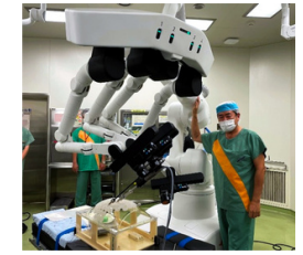
ヒノトリのオペレーションユニット。手術をするための鉗子（かんし）や内視鏡カメラを備えている。鹿児島大病院提供
